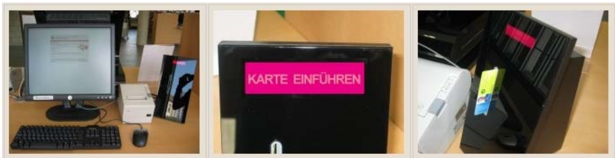
Bild 3: Ablauf eines Bezahlvorgangs: 1. Anmeldung am PC, 2. Karte in den Abwerter einführen zur Bezahlung, 3. Karte wird wieder ausgegeben und eine Quittung gedruckt
